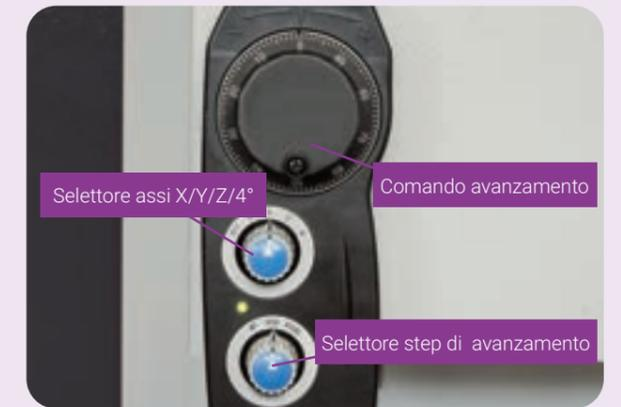
Il centro di lavoro SOGI CDL-550 vanta di serie un'unità di comando con le moderne funzionalità del SIEMENS SINUMERIK 808D ADVANCED. Il pannello operatore ha un display a colori da 8,4", una tastiera CNC completa QWERTY ed un'interfaccia USB sul frontalino. In maniera del tutto intuitiva, è possibile impostare una vasta gamma di cicli di lavoro predefiniti per realizzare forature, svasature, gole, filettature ecc.
