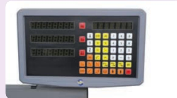
Strumento dal design funzionale e moderno che fa parte dell'equipaggiamento di serie, **in grado di visualizzare la posizione dell'utensile in 3 assi (X, Y e Z) con precisioni fino a  $0.5 \mu\text{m}$** . In combinazione con le righe ottiche, consente all'operatore di ridurre i tempi di lavorazione incrementando al contempo la produttività e l'accuratezza di esecuzione.
