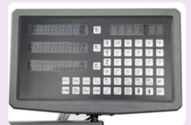
Impianto di illuminazione LED, sistema di lubrorefrigerazione tutto di serie. Mentre nella versione M4-910D è di serie il visualizzatore di quote su 3 assi; torretta registrabile in altezza.
