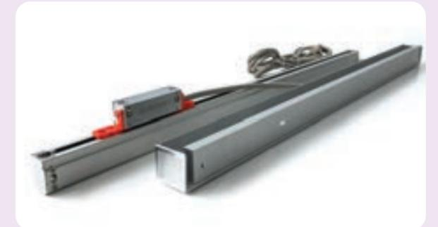
Le righe ottiche sono dei veri e propri trasduttori di posizione incapsulati in carter di alluminio: la sorgente luminosa costituente la parte mobile emette un fascio infrarosso che passando attraverso un collimatore e una riga di vetro graduata colpisce i fototransistor, generando segnali sinusoidali proporzionali al passo della gradazione. Tali segnali sono quindi elaborati per essere letti sul visualizzatore.
